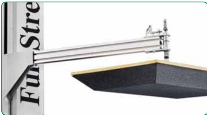
It Pressore stabilizzatore meccanico controllato da inverter.
